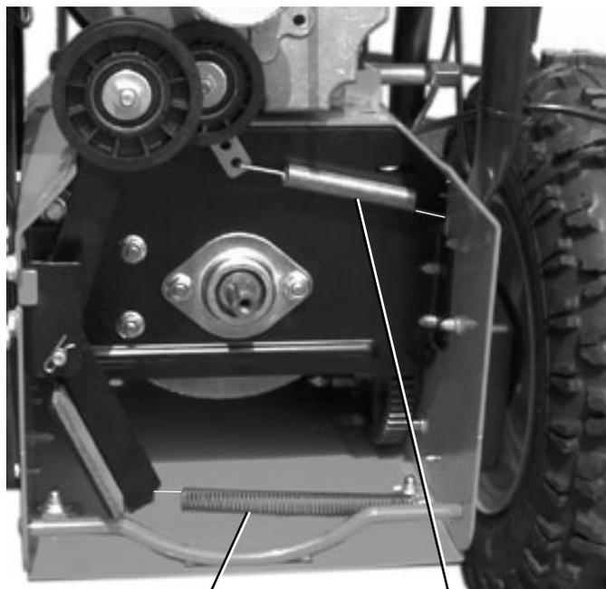
40 **AUGER BELT SPRING** **TRACTION BELT SPRING**
