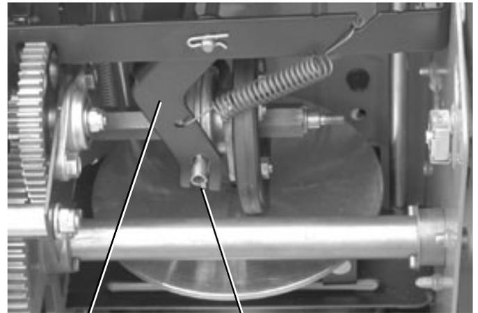
SHIFTER LEVER TRUNNION BEARING ROUND TAB
